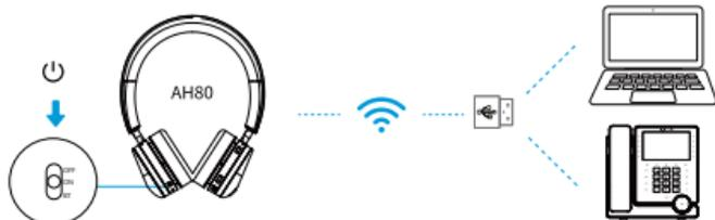
将蓝牙适配器插入电脑（或者桌面话机）的USB接口，并拨动开关按键到中间位置将耳机开机，耳机和蓝牙适配器将自动连接。
