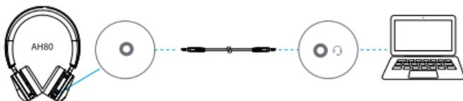
当耳机没电时，也可以通过3.5mm音频线连接进行通信或聆听音乐。
