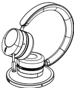
将耳机的无线充电位置（左耳侧）平放在充电底座上充电。预计2.5小时充满。建议使用符合Qi认证的无线充电器。
